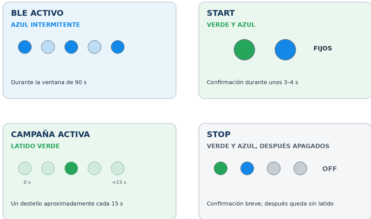
Figura 2. Patrones LED de BLE, START, campaña activa y STOP.
